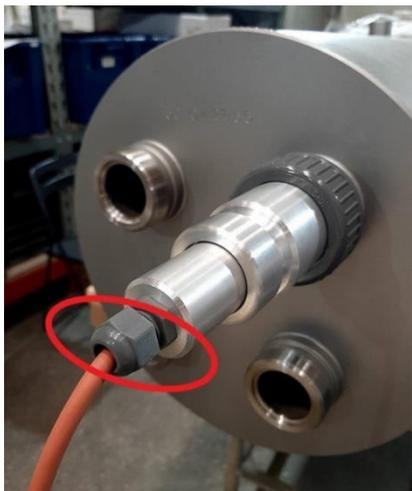
3) Отвинтите накидные гайки и снимите фиксирующие колпаки на обоих концах лампы
