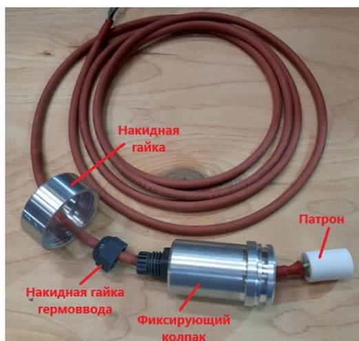
6) Затяните накидную гайку гермоввода шнура питания
